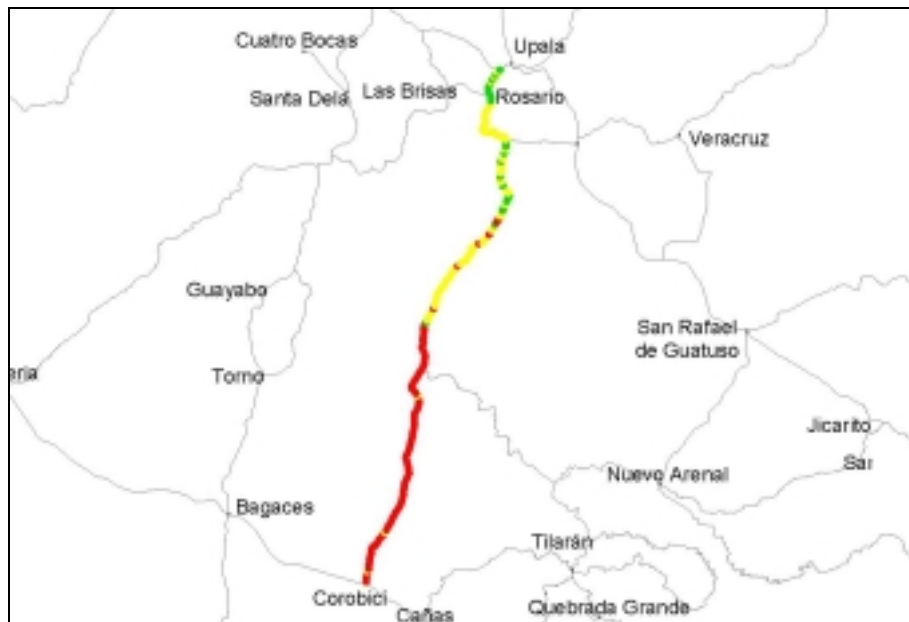
Figura 2 Condición de la Ruta 6 según las mediciones de deflexión
