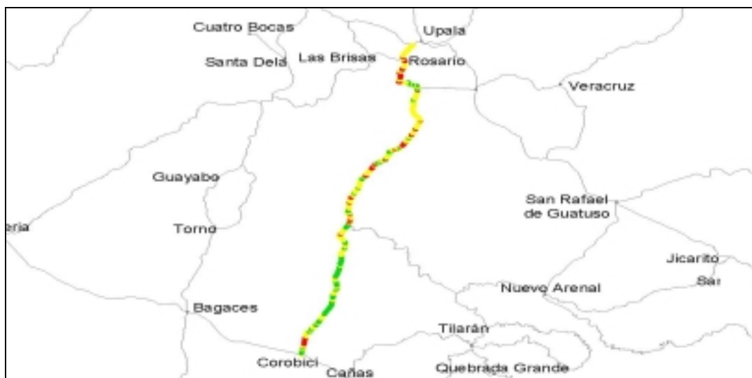
Figura 1 Condición de la Ruta 6 según el parámetro IRI
