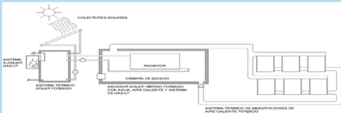
Figura 14. Esquema del sistema térmico solar híbrido con agua, aire caliente y sistema auxiliar con gas LP para secado de cacao.
