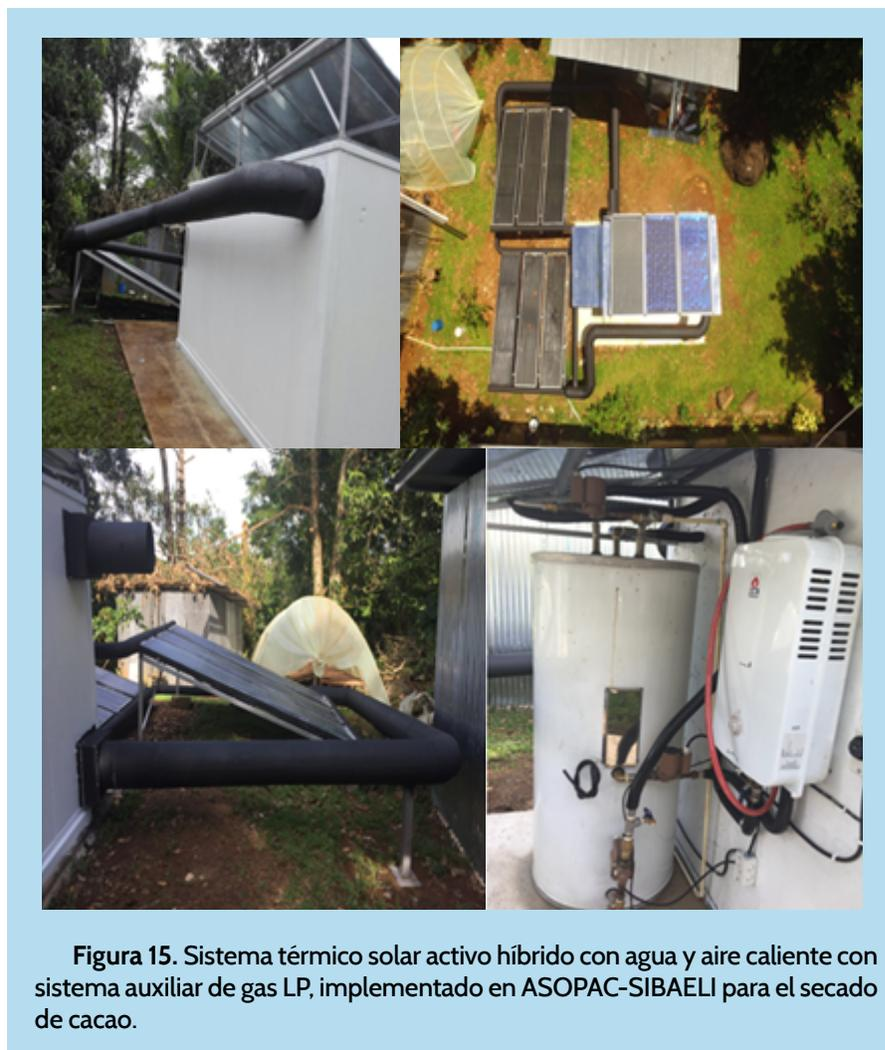
El sistema térmico solar híbrido forzado fue capaz de mantener la temperatura de la cámara de secado a 32 °C, la cual se requiere para lograr un proceso de secado adecuado para el cacao (figuras 16). Este hecho redujo
