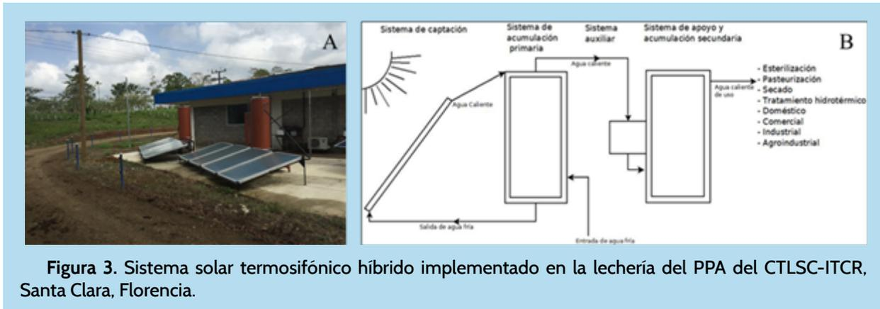
Figura 3. Sistema solar termosifónico híbrido implementado en la lechería del PPA del CTLSC-ITCR, Santa Clara, Florencia.
